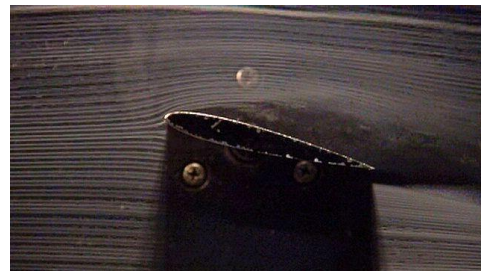
図8 可視化例（スモークワイヤー法、左：円柱周りに見られるカルマン渦の例、右：翼が大きく後縁はく離れた時の様子）
