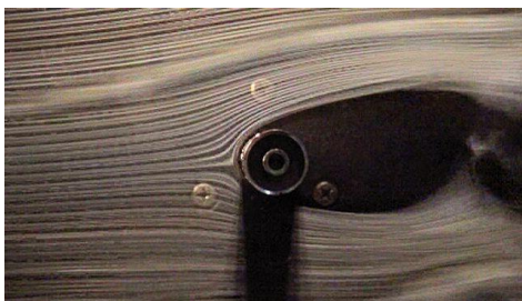
図8 可視化例（スモークワイヤー法、左：円柱周りに見られるカルマン渦の例、右：翼が大きく後縁はく離れた時の様子）
