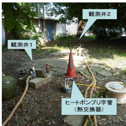
埼玉大学キャンパス内の実験サイト。深さ50mのボーリング孔が5本あり、中央のヒートポンプ用Uチューブ(赤いコーン)と観測井4本となっている。
