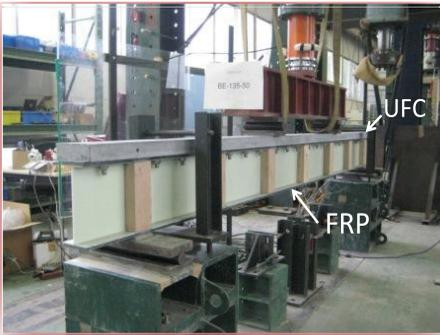
図-3 FRPとUFC 合成桁
