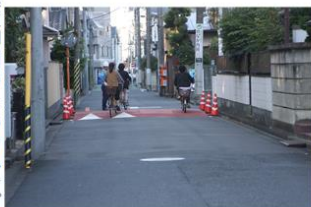
時間やリモコンによって自動で上下するライジングボラード(自動車止め 新潟市)
