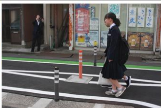
時間やリモコンによって自動で上下するライジングボラード(自動車止め 新潟市)
