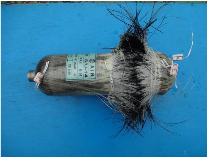
破裂した圧力容器
