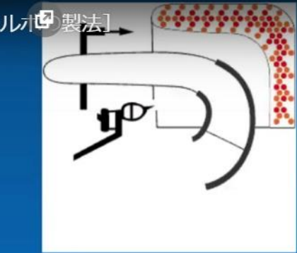
株式会社ベンカン機工 溶接式管継手の製法 エルボの製法 『マンドレル製法 (熱間曲製法) - 炭素鋼製』
