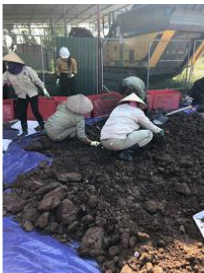
埋設廃棄物の組成調査の様子。 地元の建設会社の方々にお手伝いしていただく。 コンクリートやレンガなどを大きさごとに仕分ける。
