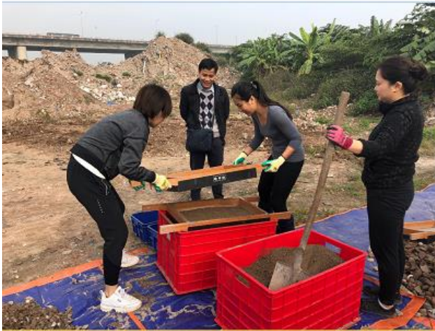
埋設廃棄物の篩分け作業。埼玉大学 学部生や大学院生、大活躍。
