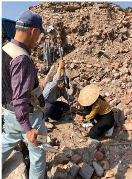
処分場内分のガスをサンプリングして、 ガス組成を調査する。
