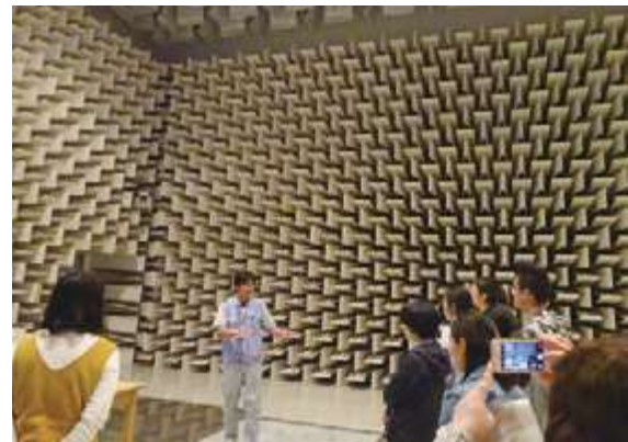
電波暗室(電波ノイズの量の測定など)
