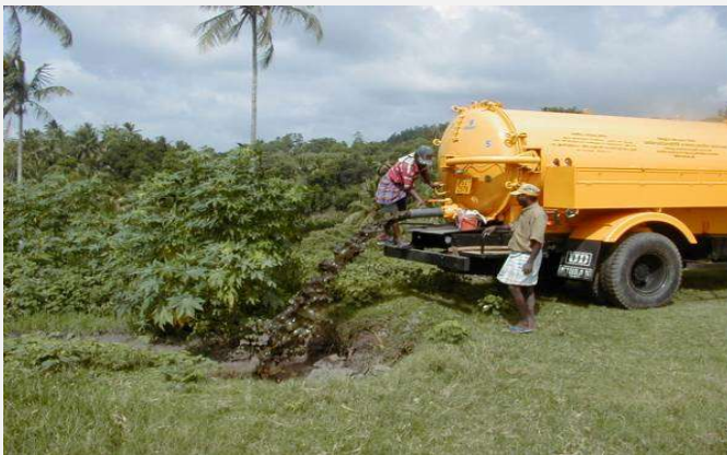
未処理のまま投棄されるし尿 （スリランカ山間地）
